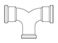
Conector en forma de T, con doble ángulo de 90° para tubería de 4′′
