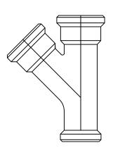
Conector en forma de Y con un ángulo de 45° para tubería de 4′′
