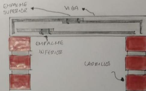
EJEMPLO DE UN TRABE DE CONCRETO ARMADO.
