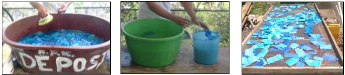
Figura 3: lavado, enjuagado y secado
