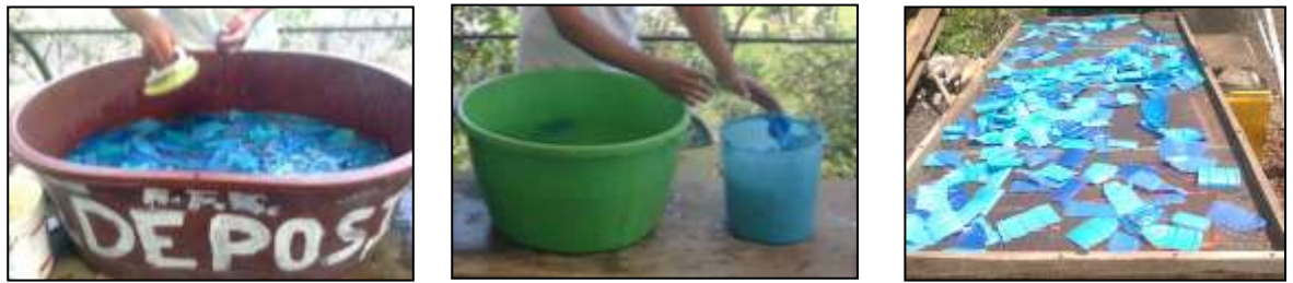
Figura 3: lavado, enjuagado y secado
