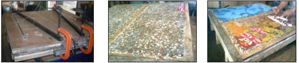
Figura 4: equipo de fundición (plancha), placa de HDPE fundido y material de recubrimiento
