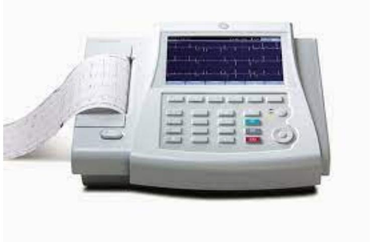
El funcionamiento del electrocardiógrafo, como equipo de diagnóstico clínico, se basa en la instalación de una serie de electrodos en la superficie de la piel del paciente a nivel de la región torácica y extremidades. Estos electrodos permiten capturar la señal eléctrica generada por la actividad del corazón del paciente.
