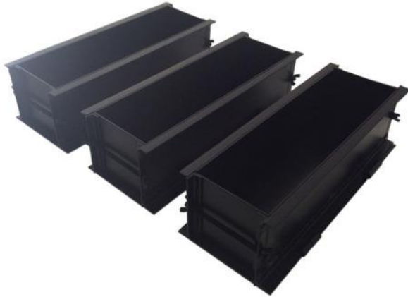
Imagen 15 Molde para viga de concreto
