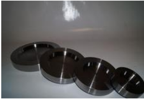
Imagen 17: Plato para cabeceador de cilindros
