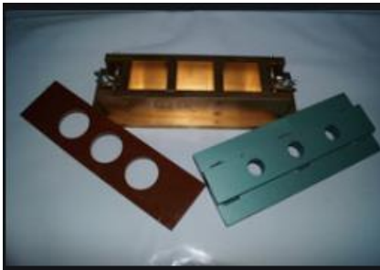
Imagen 18: Molde para cubos de mortero
