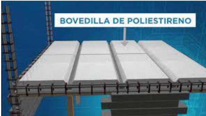
Está constituido por los elementos portantes las viguetas de concreto reforzados y las bovedillas como elementos aligerantes. Las viguetas se producen en diferentes tamaños (sección geométrica) y diferentes armados
