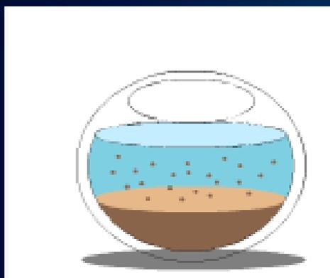
Sedimentación: Es una operación basada en la diferencia de densidades de los componentes de la mezcla, que permite separar mezclas heterogéneas de un sólido en un líquido mediante reposo o precipitación.
