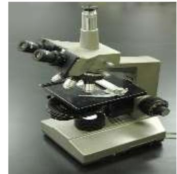
**Microscopio de contraste Interferencial diferencial (cid) o de Nomarski:** Este tipo de microscopio fue diseñado y construido basándose en los principios ópticos semejantes al microscopio de contraste de fases, porque la imagen se genera utilizando las diferencias de fase de los rayos luminosos que atraviesan el objeto observado. La diferencia con el microscopio de contraste de fases radica en que el sistema óptico, mediante un filtro especial
