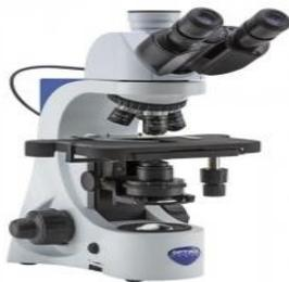
**Microscopía en contraste de fase:** se usa principalmente para aumentar el contraste entre las partes claras y oscuras de las células sin colorear. Es ideal para especímenes delgados, o células aisladas. El microscopio de fase ilumina el espécimen con un cono hueco de luz, como en el microscopio en campo oscuro. Sin embargo en el microscopio de fase el cono de luz es más estrecho y entra en el campo de visión del objetivo, que contiene un dispositivo en forma de anillo que
