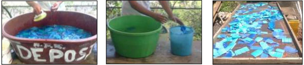
Figura 3: lavado, enjuagado y secado
