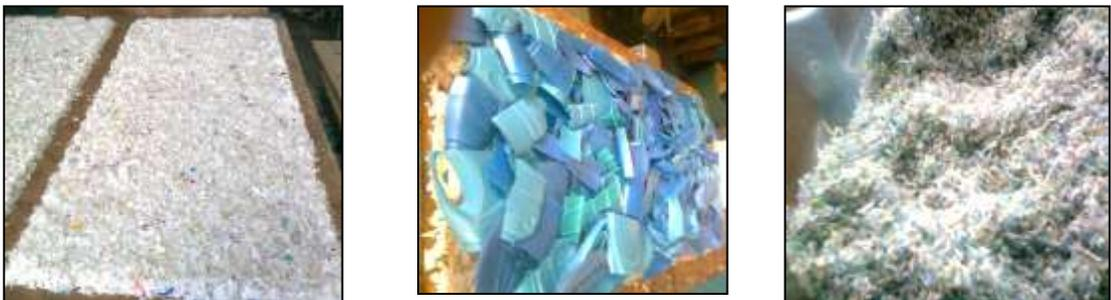
Figura 2: material triturado, material cortado y material fino (aserrín).
