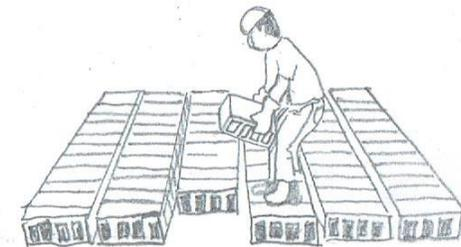
**DESCRIPCIÓN** Comenzaremos con la preparación de la losa, colocando los ladrillos de techo.
