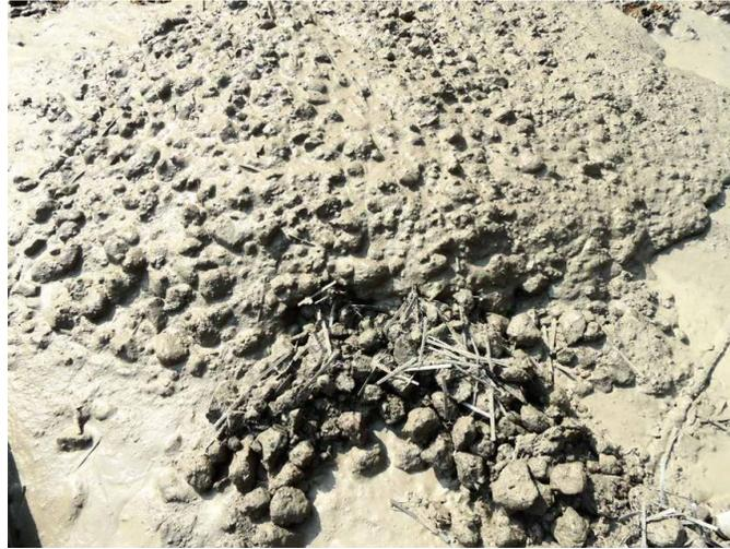
cuyos materiales antagónicos y el efecto mecánico del mezclado fibrilan y proveen un refuerzo tridimensional, comparado con el bidimensional de la malla electrosoldada.
