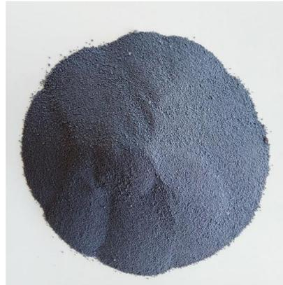
Generando silicato de calcio hidratado, el cual aumenta la resistencia y la durabilidad. La microsílíce superfina (finura 60 a 100 veces mayor que la del cemento Pórtland)
