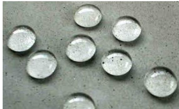
Reduce la absorción del concreto endurecido, Reduce la permeabilidad del concreto. Mejora la trabajabilidad y facilita el acabado. Reduce ligeramente el agua de mezcla del concreto, incrementando la resistencia final. Reduce la capilaridad del concreto evitando la eflorescencia. Aumenta la durabilidad del concreto.
