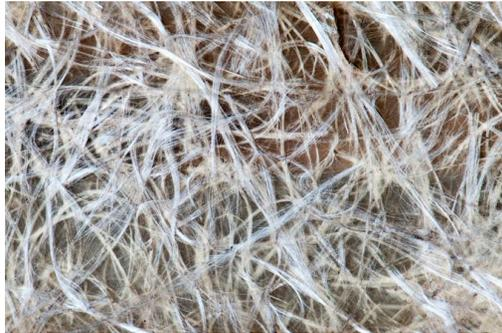
Adiciones para Concreto – Fibra Prefabricada Estructural de Poliéster
