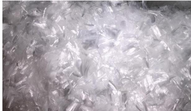
Son monofilamentos que se dispersan tridimensionalmente en la mezcla al agregarse en la planta de concreto industrializado o en la obra
