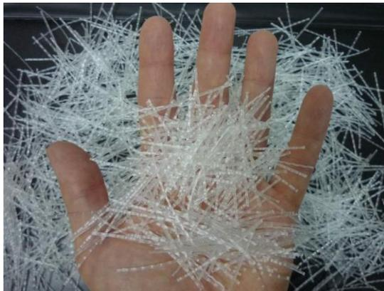
La utilización de este tipo de fibras deberá tener como principal objetivo minimizar el agrietamiento por contracción plástica, el cual se presenta en el momento de iniciarse la reagudización del concreto.
