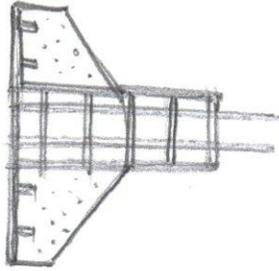
DESCRIPCIÓN Yo usare una zapata aislada ya que mi muro tendra cargas puntuales.
