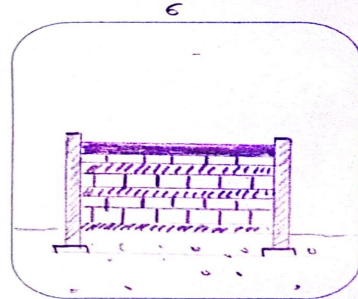
DESCRIPCIÓN: La losa se agregamos a la 3 cadena o dejamos una fila para colocarla después.
