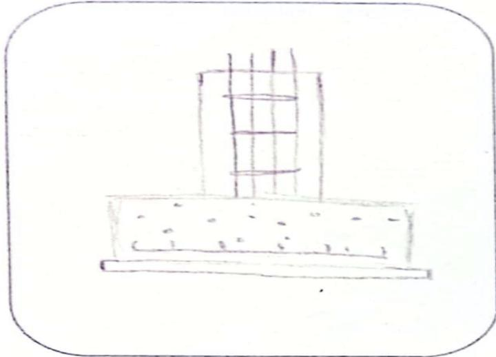
DESCRIPCIÓN: Decidí emplear una zapata aislada, sirve de base para elementos estructurales puntuales, pilares, columnas.
