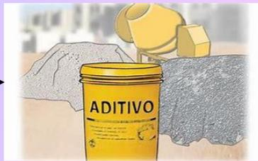
Si se emplea un aditivo inclusor de aire se debe procurar que no exceda el 6% de aire con respecto a la masa del concreto
