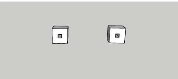
Posteriormente realizamos un cubo y le dimos volumen con la herramienta empujar/tirar, después usamos la herramienta medir y el maestro nos explicó cómo usar los ejes con esa herramienta con base a eso hicimos un cuadro más pequeño en medio del cubo y con la herramienta empujar/tirar pudimos extraer el cuadro que estaba en medio del cubo, en la imagen se puede apreciar.
