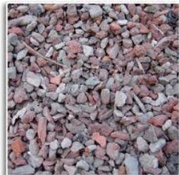
Hormigón de cascotes: que se usan piedras más pequeñas (de manera que las pueda manejar una sola persona) el peso específico es de 1600 daN/ m<sup>3</sup>
