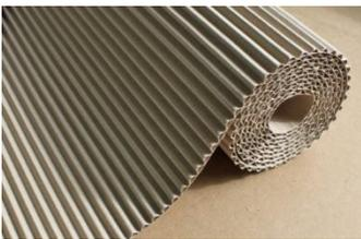
**Cartón corrugado:** es un material utilizado fundamentalmente para la fabricación de envases y embalajes, generalmente, se compone de tres o cinco papeles; los de las dos capas exteriores son lisos y el interior o los interiores ondulados, lo que confiere a la estructura una gran resistencia mecánica, La mayoría de los cartones para envases tiene un gramaje que oscila entre los 160 y los 600  $\text{g/m}^2$ .
