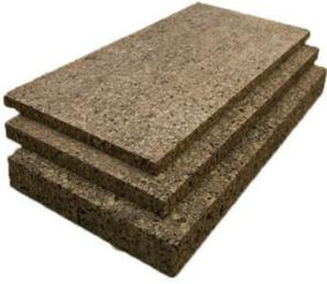
**Corcho expandido:** Las planchas o paneles de corcho negro (expandido) se utilizan básicamente como aislantes térmicos y acústicos. En su fabricación el corcho se aglutina sin necesidad de ningún aditivo químico, con su propia resina mediante un sistema de cocción que es lo que le confiere el tono tostado, peso  $120 \text{ kg/ m}^3$ .
