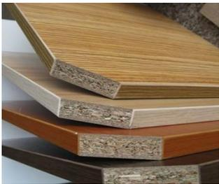
**Madera aglomerada:** La madera aglomerada se elabora al comprimir virutas de madera con pegamento. En las tablas aglomeradas planas prensadas las virutas se encuentran en su mayoría paralelas a la superficie, La densidad media del tablero aglomerado este caso será de  $700 \text{ kg/m}^3$ .
