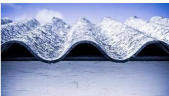
**Amianto:** Mineral que se presenta en forma de fibras flexibles, brillantes y suaves, que tiene un alto grado de resistencia a la combustión, por lo que se emplea en la fabricación de revestimientos y tejidos resistentes al fuego y al calor, Este material está presente en tejas de recubrimiento de techos, baldosas y azulejos, productos de cemento, su peso específico es de  $2000 \text{ kg/m}^3$ .
