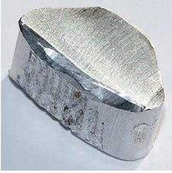
Aluminio: Elemento químico metálico, peso atómico 26.9815. El aluminio puro es blando y tiene poca resistencia mecánica, pero puede formar aleaciones con otros elementos para aumentar su resistencia y adquirir varias propiedades útiles, su peso específico es de 2.71 gramos por centímetro cúbico.
