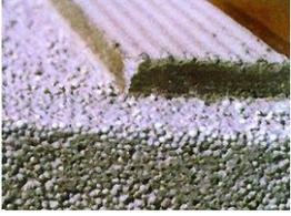
El hormigón liviano: se caracteriza por su capacidad aislante y su baja densidad, un hormigón se considera liviano cuando su densidad no excede los 2000 kg/m<sup>3</sup>, Su peso unitario varía de 350 Kg/ m<sup>3</sup> hasta 800 Kg/ m<sup>3</sup>
