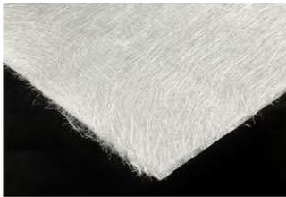
**Fibras de vidrio:** se refiere a un grupo de productos hechos de hebras extremadamente finas de vidrio tejidas (entrelazadas) en varias configuraciones o formas diferentes para formar una tela o malla dando lugar a un material flexible, muy resistente al calor, ligero, resistente a muchos productos químicos, Su peso específico es de  $2.53\text{g/cm}^3$ .
