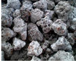
Hormigón de escoria: compuesto por una parte de cemento portland y cuatro partes de escoria de coque el peso, la densidad aparente de la escoria granulada es muy variable, entre 0,5 y 1,5 t/m<sup>3</sup>, y su peso específico es aproximadamente 2,86.
