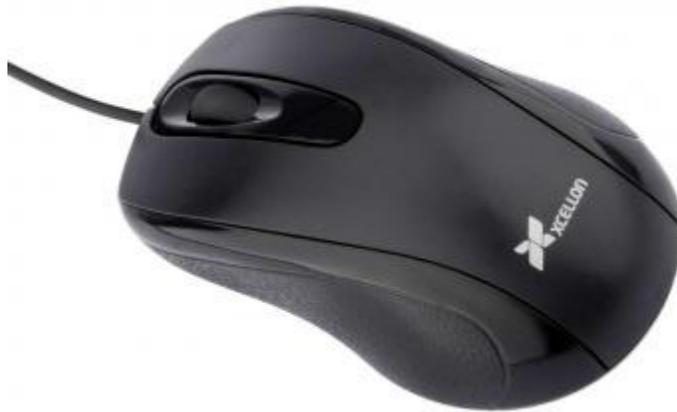
El ratón o mouse (su nombre en inglés) es un periférico de entrada utilizado para facilitar la interacción con el entorno gráfico de una computadora, básicamente es un dispositivo apuntador que detecta su movimiento sobre una superficie plana, y lo refleja en el monitor con un puntero, cursor o flecha.
