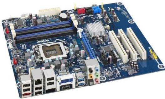
La placa base o tarjeta madre es la principal placa de circuitos impresos de la PC. Contiene rutas eléctricas o *buses* que permiten el desplazamiento de los datos entre los diversos componentes de un ordenador. Todas las partes de una computadora se conectan, de una forma u otra, con la placa base.
