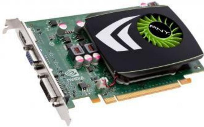
Otra de las partes de una computadora es la tarjeta gráfica. También se le llama adaptador de video, placa de video o tarjeta de video. Este componente proporciona la capacidad gráfica de una PC, la tarjeta de video se encarga de procesar los datos provenientes de la CPU y los transforma en información que puede ser vista en dispositivos de salida gráfica. Gracias a ella podemos ver imágenes, películas o juegos en el monitor de un ordenador.
