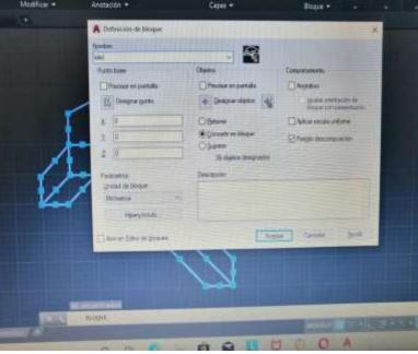
Como se puede observar en esta captura, es imposible desplazar el trazo de línea con un solo movimiento y por esto se usa el bloque. Para evitar mover trazo por trazo, es necesario utilizar el bloque, ya que con ello se vuelve uno solo.
