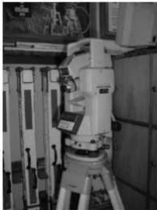
Con la estación total electrónica podemos medir distancias verticales y horizontales, ángulos verticales y horizontales; e internamente, con su micro procesador programado calcula las coordenadas topográficas (norte, este, elevación) de los puntos visados. Este instrumento posee también tarjetas magnéticas para almacenar datos, los cuales pueden ser cargados en el computador y utilizados con el programa de aplicación seleccionado.
