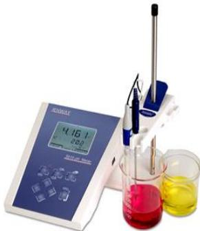
Un pHmetro o medidor de pH es un instrumento científico que mide la actividad del ion hidrógeno en soluciones acuosas, indicando su grado de acidez o alcalinidad expresada como pH.
