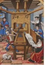
La imprenta es un método mecánico destinado a reproducir textos e imágenes sobre papel, tela u otros materiales. En su forma clásica, consiste en aplicar una tinta, generalmente oleosa, sobre unas piezas metálicas para transferirla al papel por presión.
