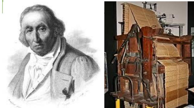
Creó el Telar de Jacquard (Jacquard's Loom) el cual empleaba tarjetas perforadas para crear patrones en una fábrica de avitelado en una tejedora.
