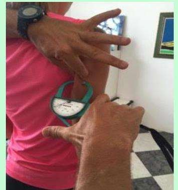
Introducimos bien el lipocalibre para tomar todo el tejido adiposo del pliegue. Presionamos sobre el lipocalibre apoyando los dedos en las dos muescas-hendiduras ralladas preparadas para ello en los laterales del lipocalibre y señaladas con la palabra “press”. Apretar hasta ver que coincidan las dos líneas, la situada bajo la escala de medida y la línea dibujada sobre la parte libre que se desplaza.
