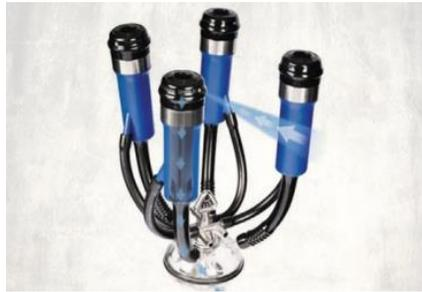
**Pulsador:** es el mecanismo que realiza los pulsos (intervalos de presión y descompresión) para el accionamiento de la pezonera.
