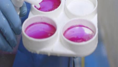
La prueba es compuesta por un detergente que mide el PH cuando es mesclado con la leche reacciona y forma un gel viscoso
