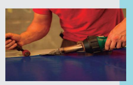
Paso 3: soldar el dobladillo Para hacer el dobladillo de la lona se dobla el borde y se fija a alta temperatura. Este paso se lleva a cabo en las cuatro partes de la lona.
