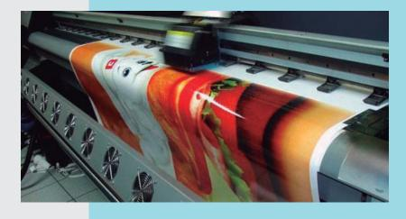
Paso 1: la impresión La lona de la manufactura es imprimida paulatinamente junto con otros productos de impresión y se enrolla de nuevo en un segundo rollo.
