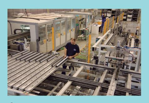
ELABORACIÓN: Después de cortar las barras de PVC, se procede a la colocación de los perfiles de refuerzo en función de las dimensiones y especificaciones del fabricante de perfiles.
