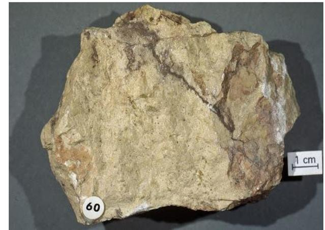
Se utiliza en forma de sillares o en placas de recubrimiento. Tiene gran resistencia en la meteorización; sin embargo la acción del agua de lluvia provoca su disolución.
