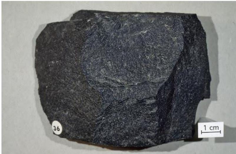
El basalto generalmente se usa para bases de carreteras. Aunque no se recomienda para ciertas obras hidráulicas debido a su excesiva fracturación.
