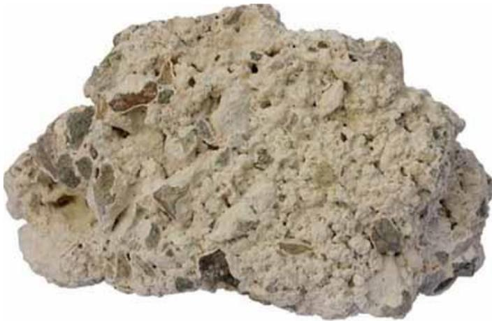
Se utiliza para sillares pero debido a su porosidad filtra la humedad causando a veces la aparición de moho.
