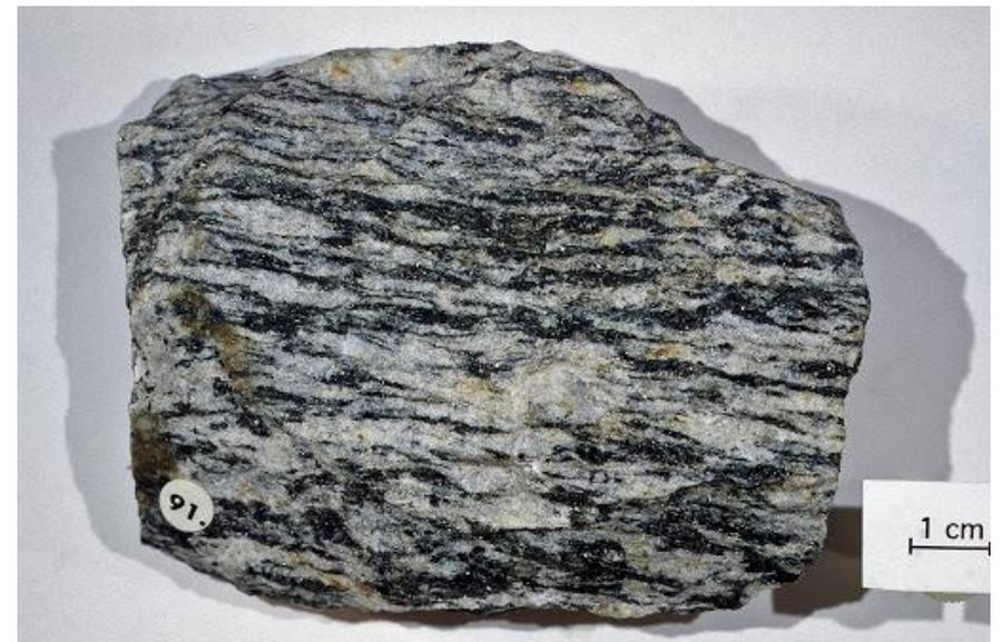
El gneis se utiliza en construcción de peldaños, adoquines, mampostería, entre otros. Es resistente al calor, la presión y el desgaste.
