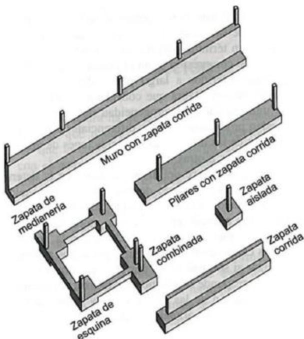
Seguimos con los demás tipos que es la superficial y la corrida y la zapata lo que es la superficial normal es donde descansan sobre el suelo, las cuales soportan la carga que recibe de la estructura por medio de la base.
