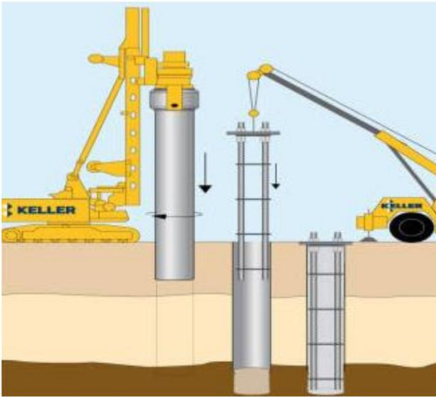
Las cimentaciones de profundas o de cajón se utilizan cuando debido a que las cargas o peso se encuentran mas hacia el centro, por lo tanto es conveniente cargar la estructura en los extremos que en el centro. cuando el terreno sea incapaz de soportar la estructura para que transmita el peso a las partes mas profundas y resistentes de la estructura o bien con pilotes que transmitan la carga a un estrato con mayor capacidad soportante.
