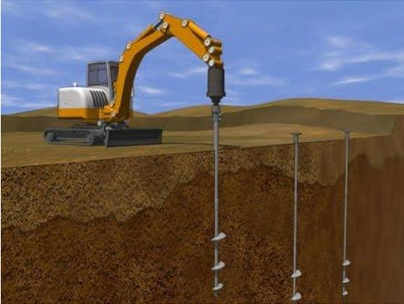
Se denominan Cimentaciones Profundas aquellas que transmiten la carga al suelo por presión bajo su base, pero que además pueden contar con rozamiento en el fuste.
