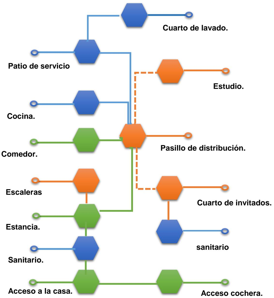
**Diagrama de funcionamiento planta alta.**
