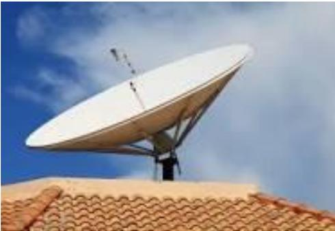
Las antenas parabólicas cuentan con un reflector generado como consecuencia de una parábola que gira sobre el eje de dicha antena. La superficie que se genera como resultado de esta acción lleva por nombre paraboloides.
