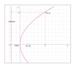
Para el esquema que realizamos, las coordenadas del vértice son V(0,0)V(0,0), las del foco F(c,0)F(c,0) y la recta directriz está dada por r:x=-cr:x=-c. Las coordenadas de un punto genérico QQ que pertenece a la directriz son (-c,y)(-c,y). Ahora con estos datos vamos a deducir la ecuación.
