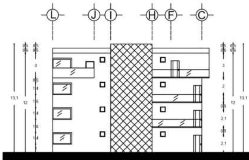
El entramado metálico está más unido, a manera de dar sombra en las ciertas horas que el sol proporciona su máxima proyección. Se eliminaron las ranuras metálicas que estaban en las puertas y cristales de los volados, de la misma manera se corrigió los volados que no corresponden las tres primeras plantas.
