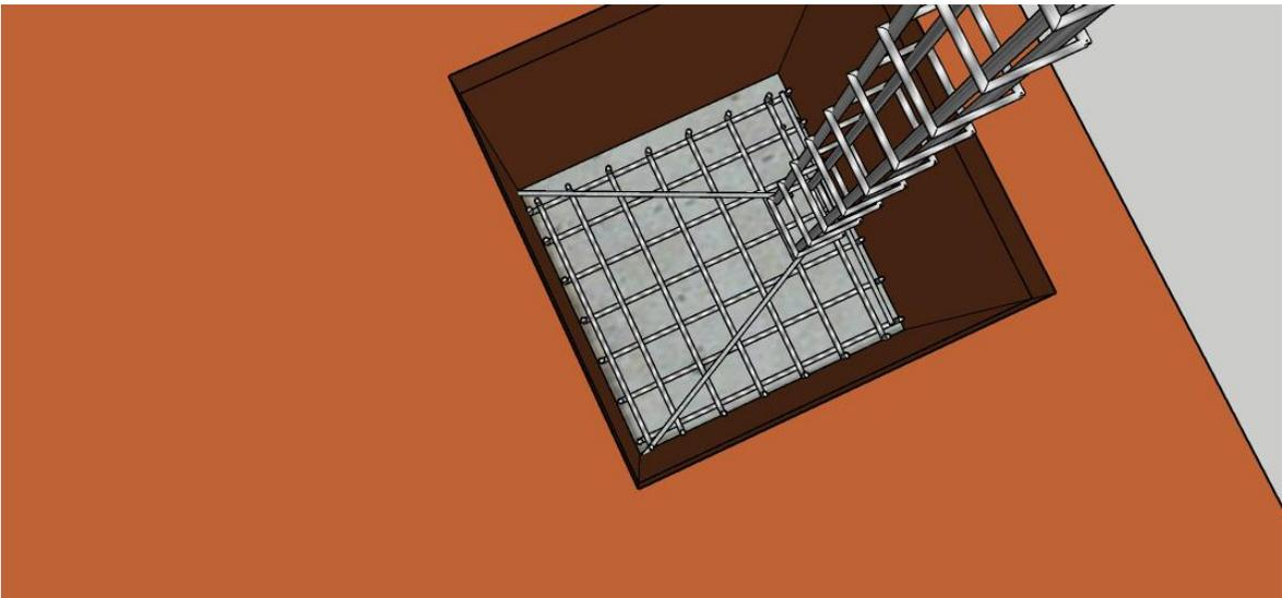
Figura 1.4 Colocación del armado de la columna
