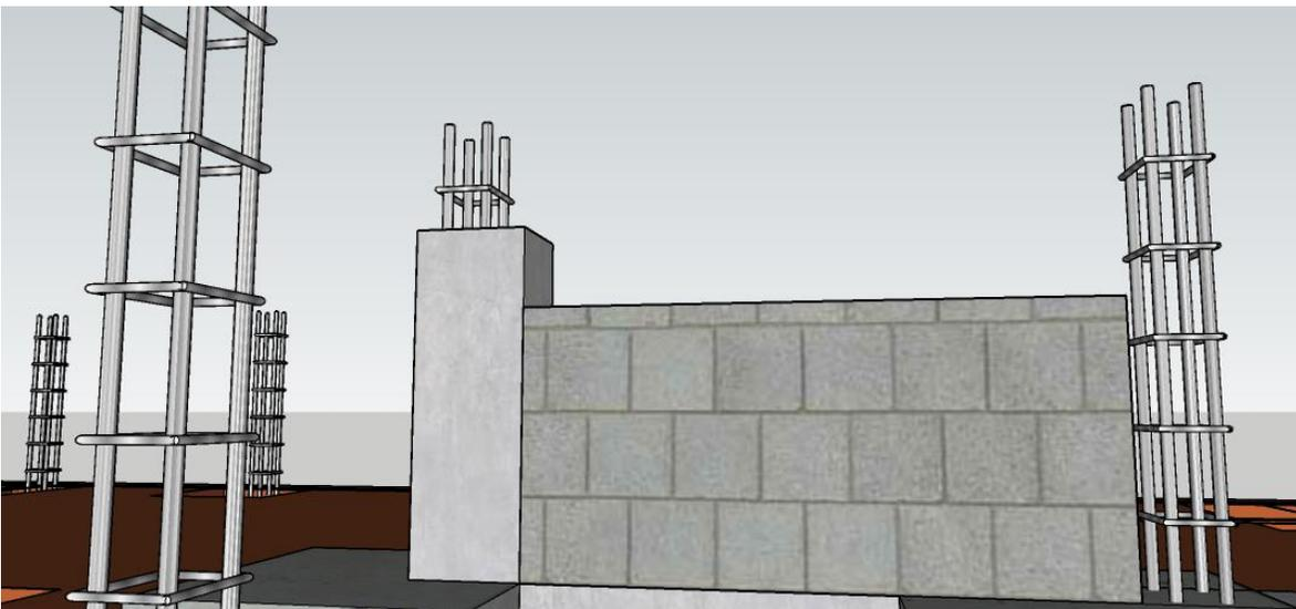
Figura 1.8 Levantamiento de muros
