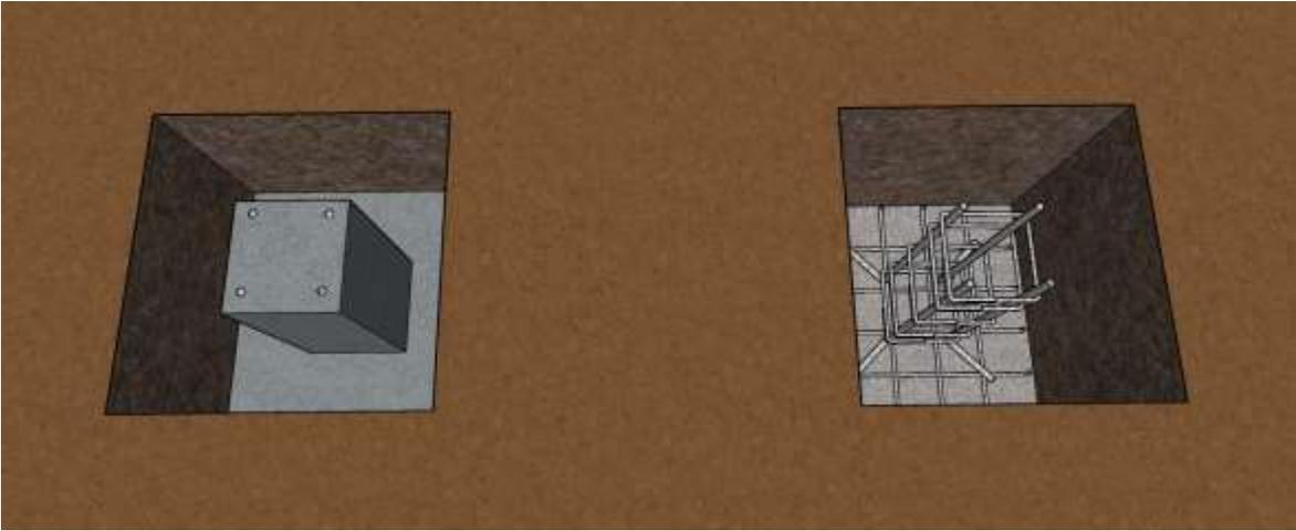
Armazón en el elemento escarbado y zapata colada
