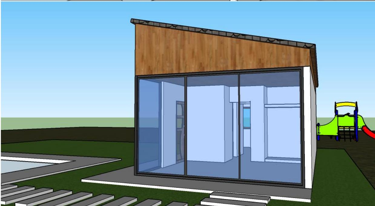
La entrada De la propuesta es básicamente Simple, hecha a partir de figuras rectangulares y barras solidas de hierro, Dentro de los materiales que se usaran son Ladrillos que imitan la piedra, Madera laminada y concreto .
