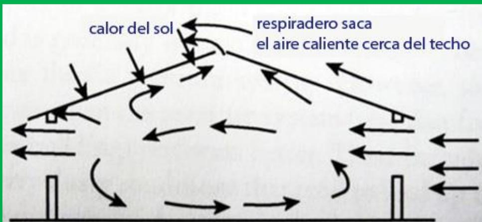
La ventilación por flotabilidad térmica funciona porque el aire caliente sube.
