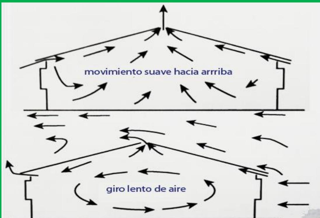
La ventilación basada en la flotabilidad es el principal método en los meses de invierno porque da lugar a una menor cantidad de intercambio de aire, mientras que el viento proporciona ventilación en el verano debido a un mayor intercambio de aire.
