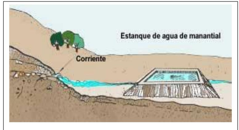
Los estanques de filtración se alimentan del agua de capas freáticas que penetra en el estanque. El nivel del agua del estanque varía de acuerdo con el nivel freático.
