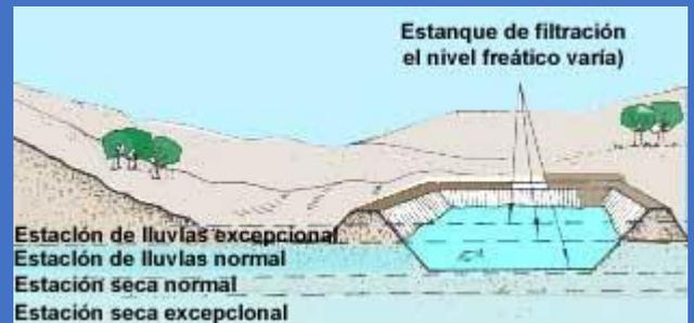
Los **estanques de agua de lluvia** se alimentan del agua caída en las precipitaciones y de la escorrentía superficial. Durante la estación seca el estanque no recibe agua. Normalmente, estas construcciones son pequeñas depresiones en suelos impermeables, con un dique construido en la parte más baja con el fin
