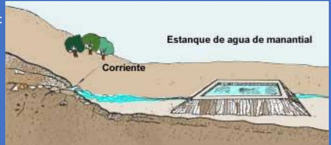
Los **estanques de filtración** se alimentan del agua de capas freáticas que penetra en el estanque. El nivel del agua del estanque varía de acuerdo con el nivel freático.
