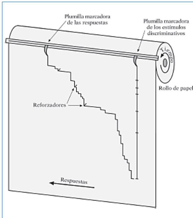
Figura 3.2 Dibujo esquemático del registrador acumulativo. Conforme pasa el tiempo, el papel se va desenrollando por debajo de las plumillas. La ocurrencia de una respuesta hace que la plumilla marcadora de las respuestas avance un paso hacia la parte superior del papel. La ocurrencia de cualquier otro evento dentro de la sesión experimental, se puede indicar a lo largo de la línea horizontal en la parte inferior del registro (o en la parte superior) usando la plumilla marcadora de los eventos.
