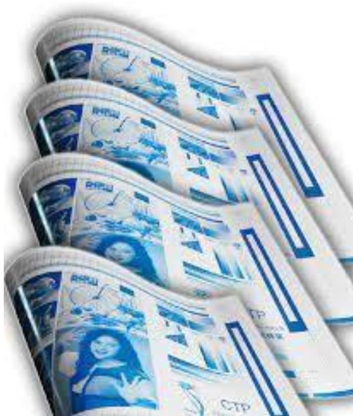
Las placas litográficas tiene una finalidad bastante interesante y es la de facilitar el proceso de impresión y que en las zonas que no queremos que se acerque la tinta puede repelerse naturalmente con el uso de agua.
