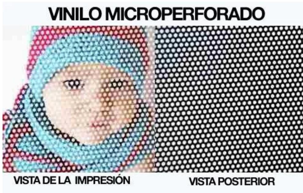
El vinilo microperforado se imprime con el uso de tintas ecosolventes o de látex, ya que estas pueden ser perforadas fácilmente sin dañar el diseño además de que son resistentes a altas temperaturas, por lo que son ideales para publicidad exterior que se encuentre a la intemperie. Se recomienda cubrirlo con un vinil auto adherible para protegerlo de la suciedad y el polvo
