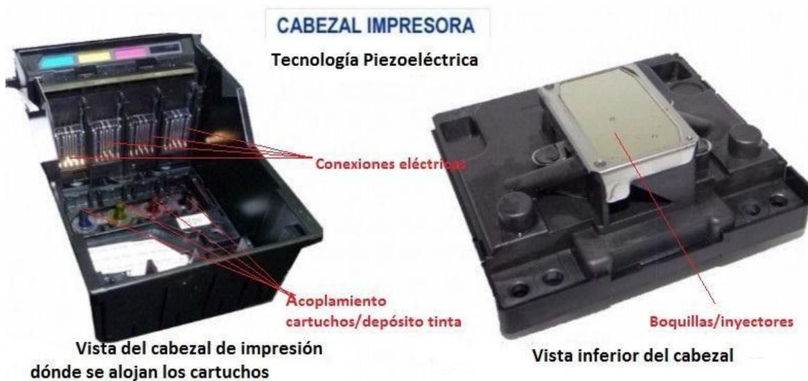
Si vamos a imprimir poco, probablemente las boquillas se secarán. Si las cabezas de impresión están en el cartucho y con una limpieza o “drenaje” no es suficiente para ponerlo en marcha, bastará con comprar otro y salvamos la impresora.
