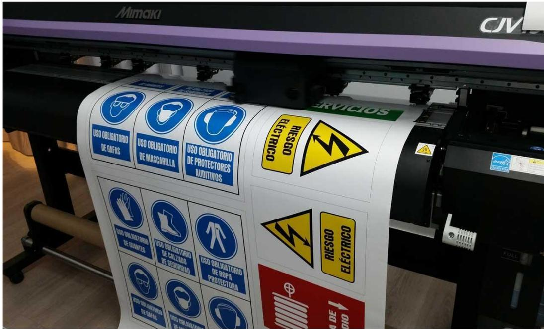
El vinilo de impresión permite crear cualquier tipo de diseño con cualquier forma que desees con una acción de agarre muy superior al vinilo de corte, pero tiene el inconveniente de que no resiste muy bien el paso del tiempo y las condiciones meteorológicas, por lo que se debe reemplazar de forma periódica.
