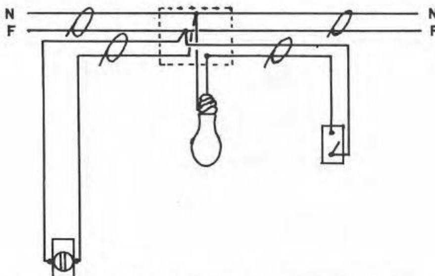
Conexión de una lámpara incandescente, controlada con un apagador sencillo y un contacto sencillo al extremo contrario del apagador, indicando llegada y continuación de la línea.
