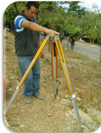
Fig. 7. Hecho lo anterior solo queda verificar visualmente que esta nivelada horizontalmente.
