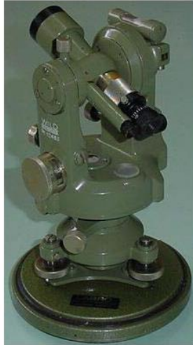
Teodolito Brújula Wild T0 con micrómetro óptico
