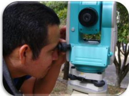
Fig. 13. Enfoque el Punto Topográfico mirando por el ocular e la plomada óptica, gire el ocular para enfocar el retículo, esto le permitirá ver claramente los círculos concéntricos del enfoque del objetivo (Reticulo).
