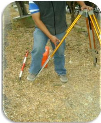
Fig. 6. Se ajusta la cabeza para que quede nivelada, esto se hace asegurando que las puntas de las patas queden seguras y no se muevan. Una vez hecho esto proseguimos a aflojar los tornillos para subir o bajar la plataforma donde se
