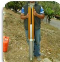
Fig. 3. El trípode se posiciona a la altura de la barbilla.
