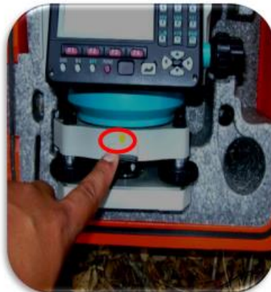
Fig. 8. Se procede a abrir el maletín donde está la estación, procurando hacerlo en la posición que se ilustra en la figura.
