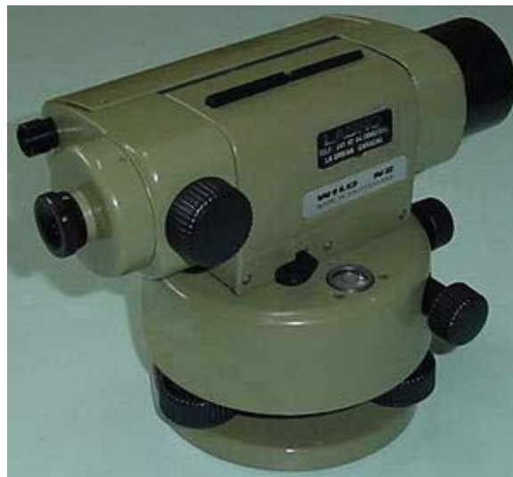
El nivel Wild N2 con nivel tórico de doble curvatura.
