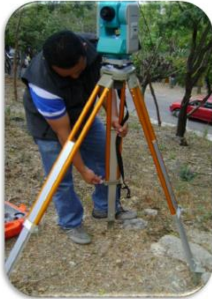
Fig. 18. Centrar el nivel esférico esto se logra ajustando las patas del tripie, por conveniencia, dejar fija una de las patas y ajustar las otras.
