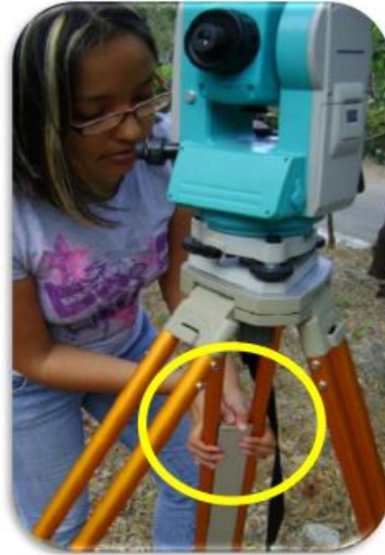
Fig. 19. Se debe tener muy en cuenta la manera de ajustar las patas, se observa en la figura que ambas manos deben sostener los tubos para facilitar el deslizamiento de la barra para obtener una mejor precisión en el nivel circular.
