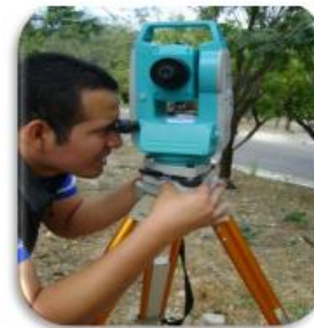
Fig. 16. mirando por el ocular deslice suavemente el instrumento sobre la cabeza del tripiode hasta que el
