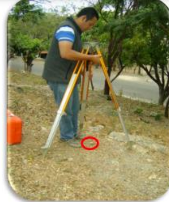
Fig. 5. Se procede a separar las patas con separaciones iguales y sobre el punto observado.
