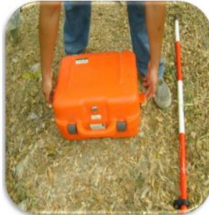
Fig. 8. Se procede a abrir el maletín donde está la estación, procurando hacerlo en la posición que se ilustra en la figura.
