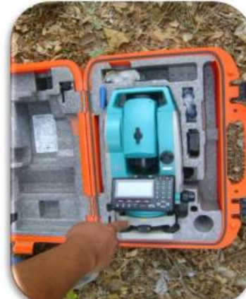
Fig. 9. Una vez abierto el maletín se tiene que poner mucha atención en la manera en como viene la estación de tal manera que no se maltrate.
