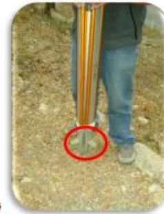
Fig. 2. Se procede a colocar el trípode sobre el punto de observación.
