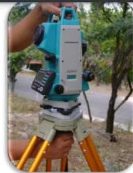
Fig. 12. Se coloca el instrumento sobre la cabeza del tripie, y sujetando con una mano al instrumento apriete el tornillo de fijación.
