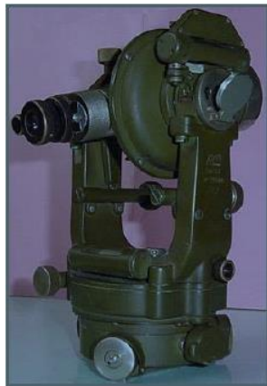
Teodolito Kern DK-2 con sistema de lectura de coincidencia
