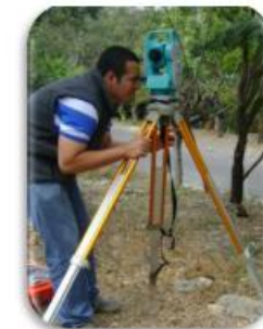
Fig. 14. con el ocular de la plomada óptica fije el punto de observación; dejando fija una de las patas y moviendo las otras dos hasta encontrar el punto.
