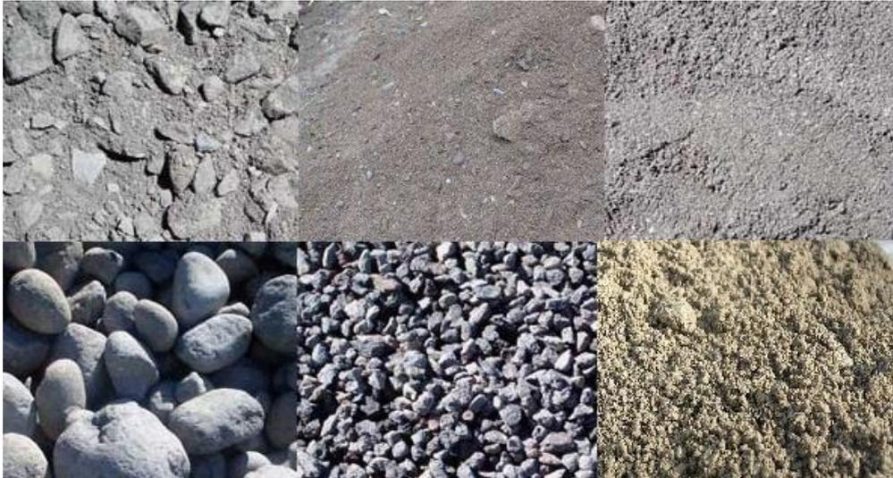
Son aquellos materiales que se obtienen mezclando un material aglomerante o conglomerante, agua, otro elemento que puede ser un material pétreo, orgánico, etc., y aditivos y/o adiciones cuando sea necesario. Necesitan de un fraguado y un endurecimiento. Se les llama pétreos porque después del fraguado se quedan en estado petrificado, es decir, el producto final forma un todo uno.
