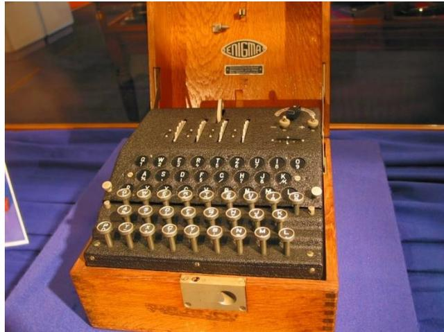
Inventada por el ingeniero alemán Arthur Scherbius en el año 1923, la máquina Enigma consiste en un banco de rotores montados sobre un eje, en cuyos perímetros había 26 contactos eléctricos, uno por cada letra del alfabeto inglés. En realidad, el precursor de este tipo de máquinas con rotores fue Edward Hugh Hebern que algunos años antes inventa y comercializa los denominados cifra dores de códigos eléctricos
