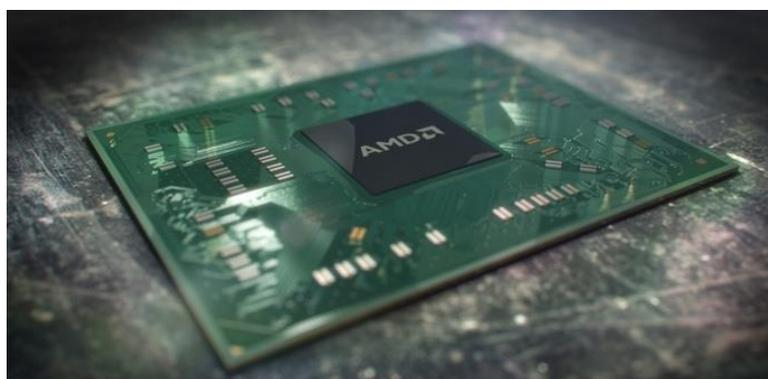
En la actualidad, tanto AMD como Intel cuentan con gráficas integradas en sus procesadores. El principal motivo es que los procesadores gráficos son muy potentes a la hora de realizar procesos paralelos, y ubicar la GPU junto con la CPU permite utilizar los gráficos integrados para realizar muchos procesos además del procesamiento de gráficos propiamente dicho (Ver **arquitectura de sistemas heterogéneos**).
