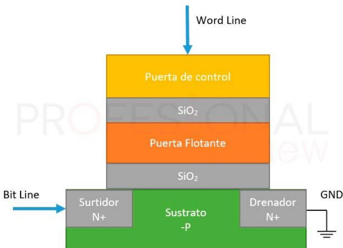
**Estas puertas NAND están fabricadas mediante transistores de puerta flotante**, que es un elemento en donde se almacenan los bits. Para el caso de las memorias RAM estos transistores necesitan de una alimentación continua para mantener su estado y en las memorias flash no. **Cuando un transistor de puerta flotante está cargado tiene en su interior un 0, y cuando está descargado tiene un 1.**
