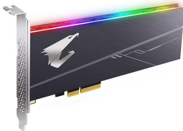
Mediante esta interfaz, las unidades irán conectadas directamente a las **ranuras de expansión PCI-Express** de nuestra placa base. De esta forma, es posible alcanzar velocidades de transferencia de **hasta 3940 MB/s en lectura y escritura utilizando 4 carriles (x4) en la versión 3.0 y hasta 7880 MB/s en la versión 4.0**. En la actualidad, casi todos los SSD PCIe van conectados a la **ranura M.2**. El protocolo de comunicación se denomina **NVMe**, y está en su versión 1.3 y 1.4.
